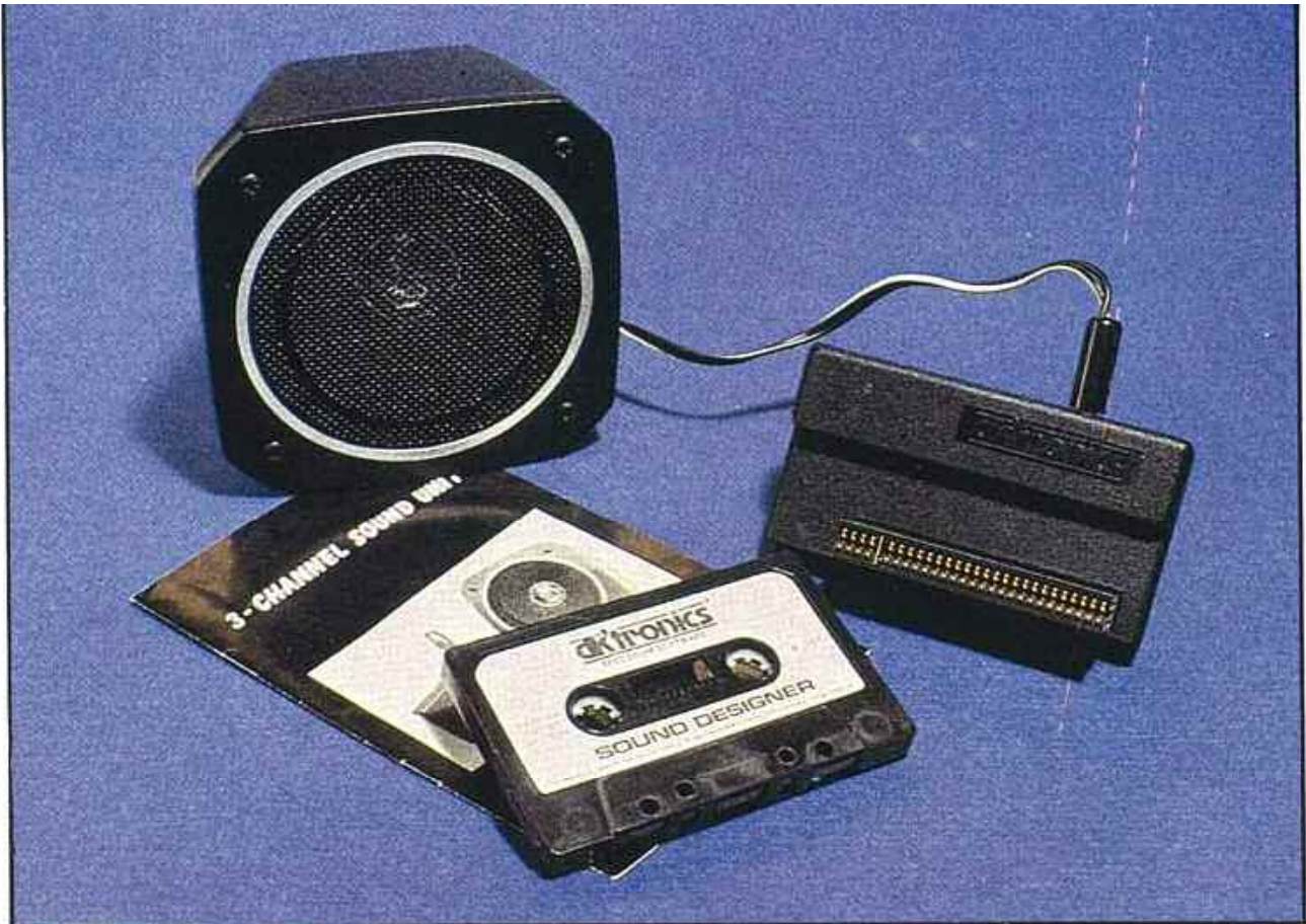
Las posibilidades sonoras del Spectrum quedan notablemente mejoradas con el uso de este sintetizador musical de tres canales.
