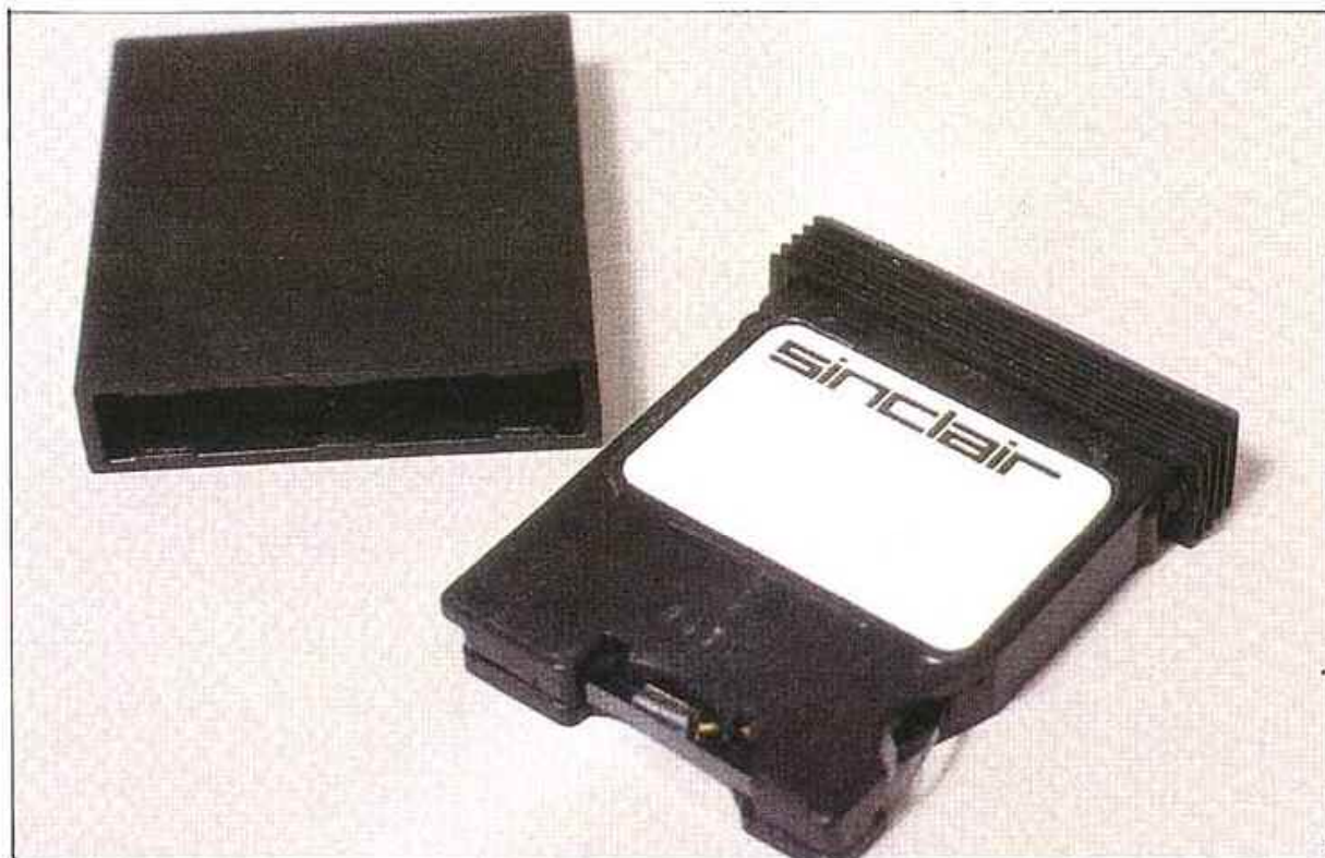
Almacenamiento en cartucho «Microdrive».
